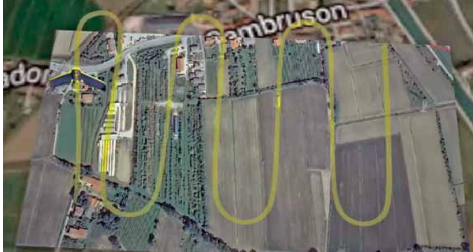
Percorso del volo di un drone dotato di fotocamere digitali per il rilievo georeferenziato: è possibile rilevare il tipo di coltura ed eventuali danni, ecc. individuando da subito la particella catastale dell'appezzamento sorvolato.
